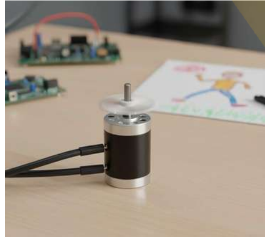
Figura 14. 1 Motore con ventola collegata
