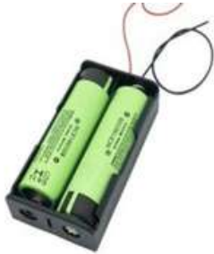
Abbildung 11. Batteriehalter mit Batterien
