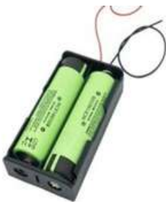
Abbildung 6. Batteriehalter mit Batterien
